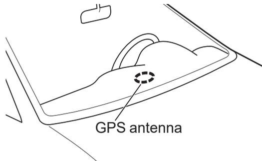
Penghitungan posisi kendaraan dan pengaturan tanggal dan waktu yang dilakukan melalui penerimaan sinyal radio yang lemah dari satelit GPS dengan “antena GPS”.
