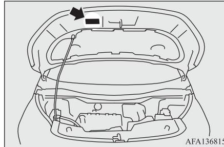
Plat ini menunjukkan kode model, model mesin, model transmisi, dan kode warna body, dll. Gunakan nomor ini ketika memesan part-part pengganti.
