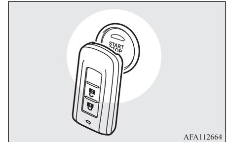
3. Jika kunci *keyless operation* dikenali, lampu indikator pada *engine switch* akan menyala hijau, lalu mesin akan menyala dan mode pengoperasian dapat diganti dalam waktu sekitar 10 detik. Lihat “Menghidupkan mesin” dan “Mengganti mode pengoperasian” pada BAB 6.
