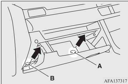
3. Geser *glove box* pada satu sudut untuk melepas kaitan pada pengait (C) pada tiap sisi, kemudian tarik *glove box* untuk melepaskannya.
