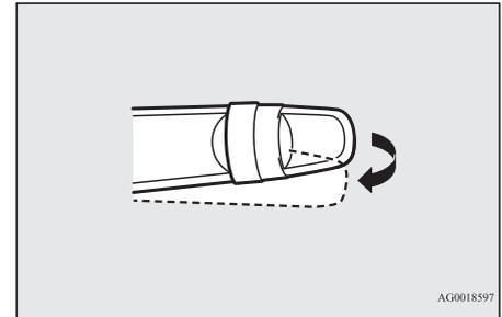
4. Lampu depan akan menyala pada pengaturan lampu dekat selama sekitar 30 detik. Setelah lampu depan mati, lampu depan dapat dinyalakan lagi pada pengaturan lampu dekat selama sekitar 30 detik dengan menarik tuas sinyal belok ke arah anda selama 60 detik dari menempatkan mode pengoperasian pada posisi OFF.
