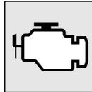
Lampu ini adalah bagian dari *onboard diagnostic system*, yang memonitor emisi, sistem kontrol mesin atau sistem kontrol CVT.
