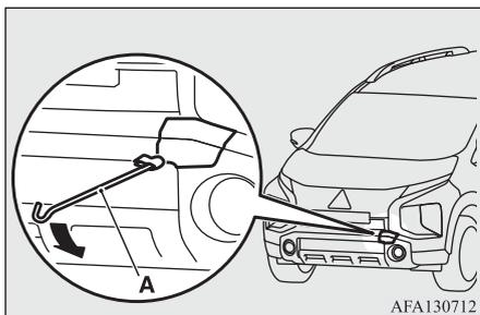
3. Gunakan batang dongkrak untuk memasang pengait derek (B) dengan kuat.
