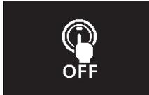
Jika mode pengoperasian berada di posisi selain OFF, jika anda menutup semua pintu dan pintu bagasi lalu mencoba mengunci dengan menekan tombol *lock/unlock* pada pintu pengemudi atau penumpang depan, atau tombol *lock/unlock* pintu bagasi, tampilan peringatan akan muncul dan *buzzer* luar akan berbunyi dan anda tidak dapat mengunci pintu.
