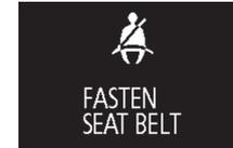
Jika kunci kontak diputar ke posisi “ON” atau mode pengoperasian dalam posisi ON sementara sabuk pengaman tidak digunakan, lampu peringatan menyala dan suara berbunyi sekitar 6 detik mengingatkan pengemudi dan penumpang depan untuk mengencangkan sabuk pengaman.
