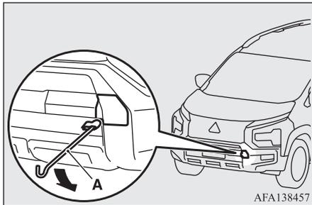
3. Gunakan batang dongkrak untuk memasangkan pengait derek (B) dengan kuat.
