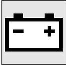
Lampu ini menyala ketika mode pengoperasian diubah ke posisi ON, lalu padam setelah mesin dinyalakan.
