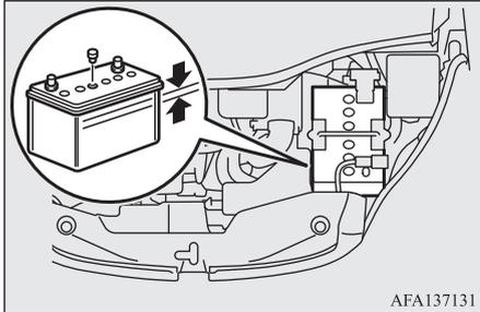
Ketinggian elektrolit harus di antara batas yang ada di bagian luar baterai. Isi ulang dengan air terdistilasi (air aki) sesuai kebutuhan.
