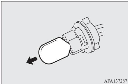
6. Untuk memasang bohlam, lakukan kebalikan dari langkah pelepasan tadi.
