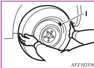
7. Putar mur roda searah jarum jam dengan tangan untuk pengencangan awal. Kencangkan sementara mur roda dengan tangan sampai bagian *flange* pada mur roda menyentuh roda dan roda tidak kendur.
