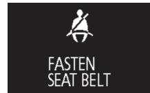
Jika kunci kontak diputar ke posisi "ON" atau mode operasi dalam posisi ON sementara sabuk pengaman tidak dikencangkan, maka lampu peringatan akan menyala dan terdengar bunyi selama sekitar 6 detik untuk mengingatkan pengemudi dan penumpang depan untuk mengencangkan sabuk pengaman.
