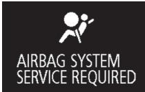
Terdapat lampu peringatan *supplemental restraint system* ("SRS") pada panel instrumen. Sistem akan memeriksa sendiri ketika kunci kontak atau diubah ke posisi "ON". atau mode operasi dalam posisi ON. Lampu peringatan SRS akan menyala selama beberapa detik kemudian akan padam. Hal ini normal, dan berarti sistem sudah berfungsi normal.
