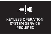
KEYLESS OPERATION SYSTEM SERVICE REQUIRED                                              | Buzzer di bagian dalam akan berbunyi sekali. | Terdapat masalah pada <i>Keyless operation system</i> .
