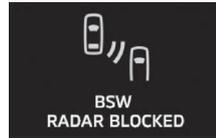
Saat muncul tampilan peringatan, sensor tidak dapat mendeteksi kendaraan yang melaju berdampingan atau mendekati kendaraan, karena benda asing, seperti lumpur, salju atau es, menempel di permukaan bumper sekitar sensor. Lepaskan lumpur, es atau benda asing di permukaan bumper sekitar sensor. Saat tampilan peringatan tidak hilang setelah membersihkan sensor, maka hubungi dealer resmi MITSUBISHI MOTORS.
